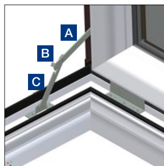
Aby ustawić skrzydło w pozycji zahamowanej otwartej należy umieścić część skrzydłową ogranicznika otwarcia/zamknięcia A w gnieździe B części ramowej ogranicznika C
