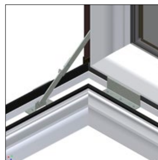
Zablokowany ogranicznik otwarcia/zamknięcia - pozycja zahamowana, skrzydło otwarte ok. 90°
